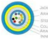
JACKET ARAMID YARN STEEL TUBE COLOR CODED FIBER ARAMID KEVLAR INNER JACKET
